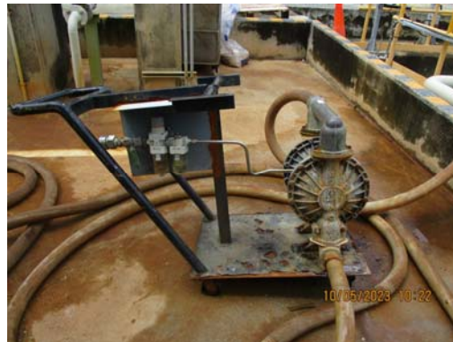
รูปที่ 3.17 Diaphragm Pump
